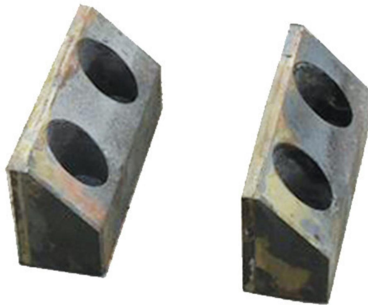
چکش و رینگ دندانه ای آسیاب میکرونیزه
